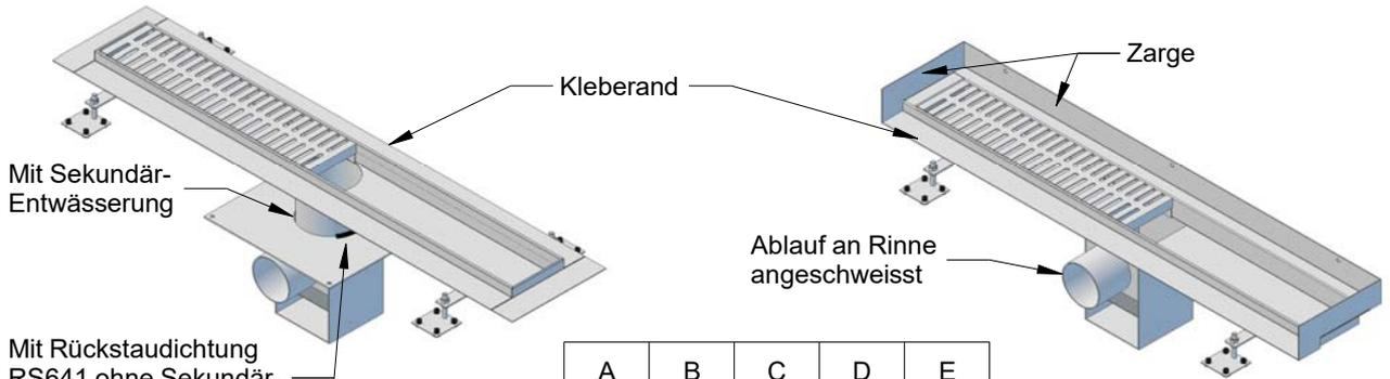
Mit Rückstaudichtung RS641 ohne Sekundär-Entwässerung
