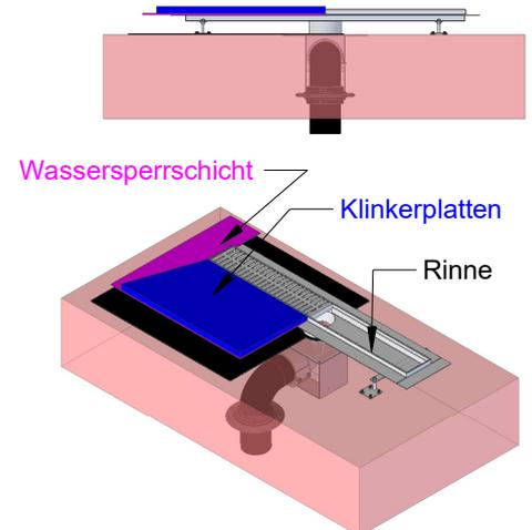
Ablauf RS523.70 mit Rückstaudichtung RS644.70 in PE-Rohr ø110 mm
